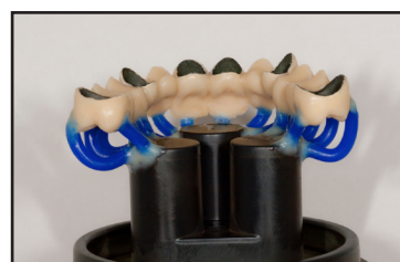
Fig. F Note the two sprues on each posterior
